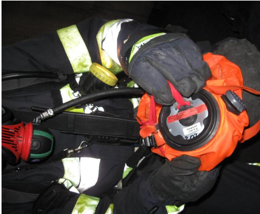
Abb.: Entnehmen des Verschlussstopfens
