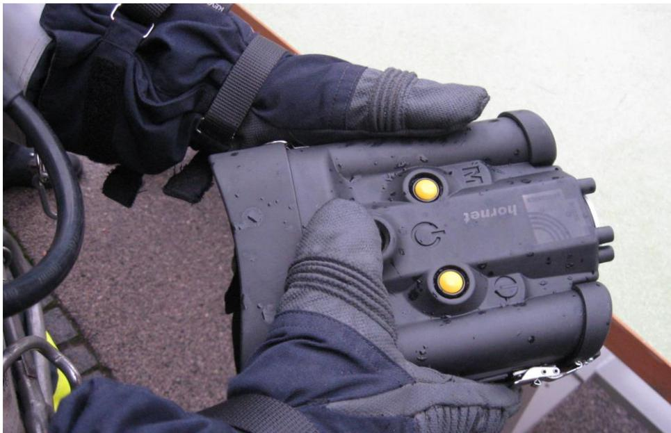
Abb.: Einschalten der Wärmebildkamera durch den ASTRF
