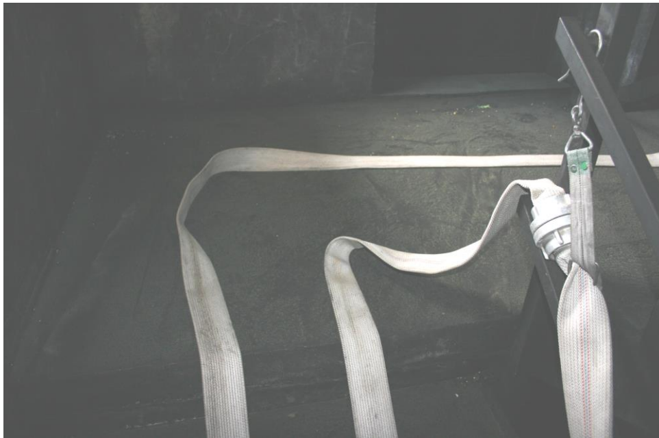
Abb.: Sicherung der Angriffsleitung durch die takt. Nummer 2 mittels Schlauchhalter
